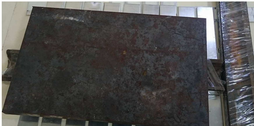
Figura 27 – Foto dos pesos sendo colocados nos corpos de prova
