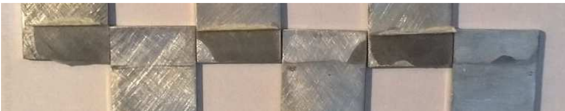
Figura 33 – Corpos de provas fraturados Cianoacrilato 12.5mm
