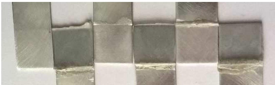
Figura 35 – Corpos de provas fraturados cianoacrilato 25mm
