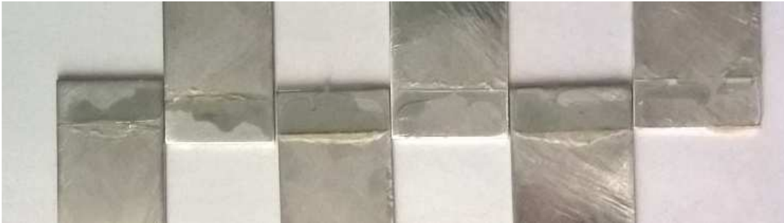
Figura 32 – Corpos de prova fraturados (epóxi 12.5mm)
