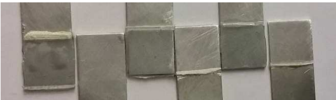
Figura 34 – Corpos de provas fraturados epóxi 25mm
